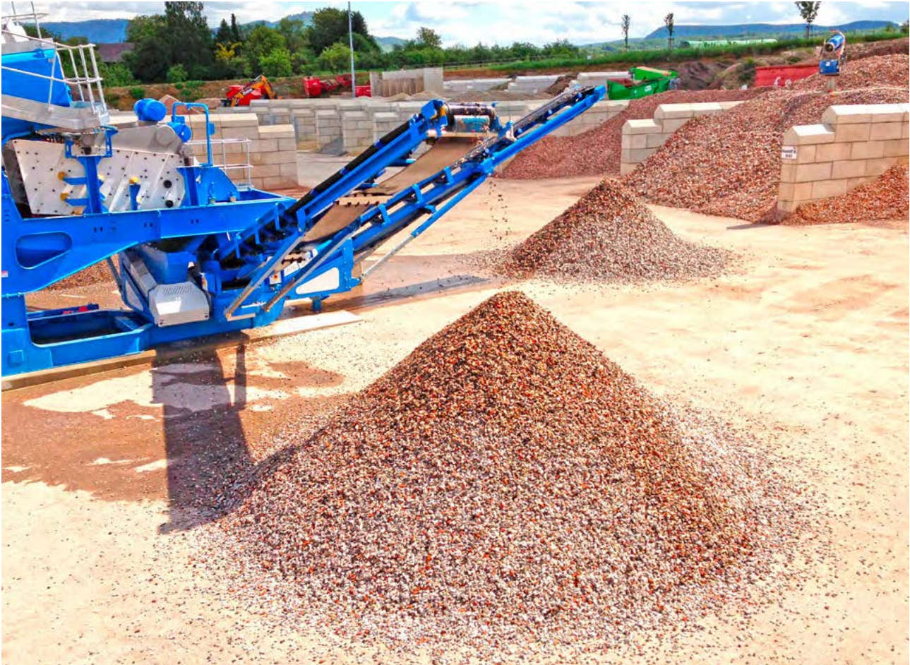
Abbildung 6: Recycling – Output-Material: sortenreines Splitt-, Kies-, Schottermaterial
