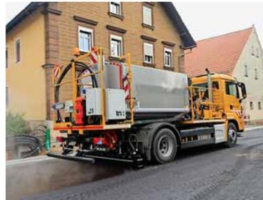
WEIRO® Anspritzmaschine HK-1000-PH auf LKW-Fahrgestell mit 6000 l Nutzinhalt und hydraulisch ausfahrbarem Spritzbalken, zur Herstellung des Schichtenverbunds, zusätzlich Rührwerkskocher mit 500 kg Nutzinhalt für die Versiegelung von hohem Rand und Arbeitsnaht. Weitere Optionen sind Dieseltransportbehälter mit unterschiedlichen Nutzinhalten zur Betankung weiterer Baumaschinen, Vorbaukehrwalzen, Wassertankanlagen usw.
