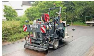
Selbstfahrende WEIRO® Anspritzmaschine TM-800-SH mit 800 l Nutzinhalt. Die extreme Wendigkeit des Dreirad-Fahrgestells ermöglicht den Einsatz auch auf kleineren Baustellen. Die exakte Bindemitteldosierung, optional mit rechnergestützter Dosierautomatik, sichert den schlüssigen Verbund zwischen den Asphaltsschichten.
