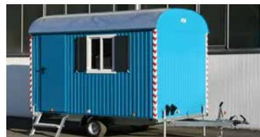
WEIRO® Bauwagen RASANT Typ BME-C 21 S, Schnellläufer-Bauwagen mit 3,50 m Aufbauhöhe, verzinktem Fahrgestell, Kugelkupplung, Fußboden aus einem geschäumten PU-Sandwichelement und Sonderlackierung
