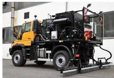
WEIRO® Anspritzmaschine HK 1000 PH, aufgebaut auf Unimog U 530. Das multifunktionale Maschinensystem mit Anspritzsystem (Nutzinhalt 2.000 l) und hydraulisch ausfahrbarem Spritzbalken (max. Arbeitsbreite 4,50 m) und 700 kg Rührwerkskocher für die Versiegelung von hohem Rand und Arbeitsnaht. Die Anbau-platte mit Fronthydraulik kann zusätzlich eine Kehrwalze betreiben.
