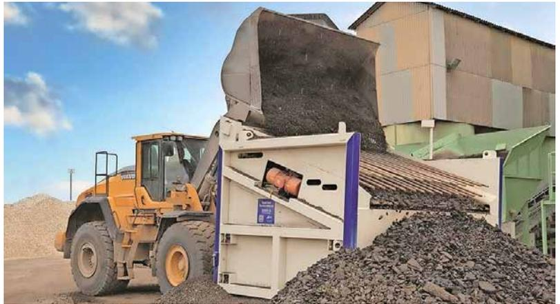
Beschickung der SBR 4 – unabhängig vom Mischprozess dank Sensorsteuerung
