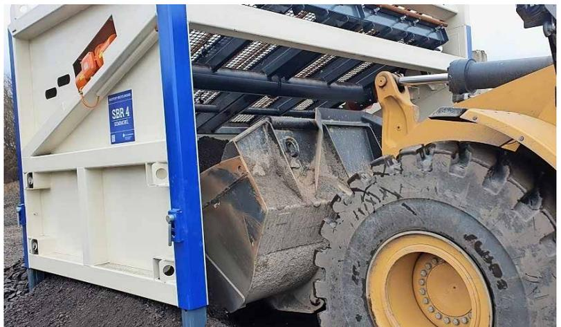
Entnahme des Unterkorns – gesparte Brechtonnage
