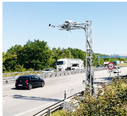
Schematische Darstellung des EDAR-Messsystems und Aufbau der Anlage an der BAB A 61 im Juni 2022.
