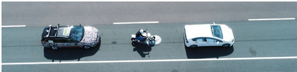
BeispieltestszENARIO „Stau-Ende mit Motorrad“ für ein ALKS.
