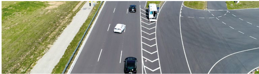
BeispieltestszENARIO „Einscherer“ für ein ALKS.
