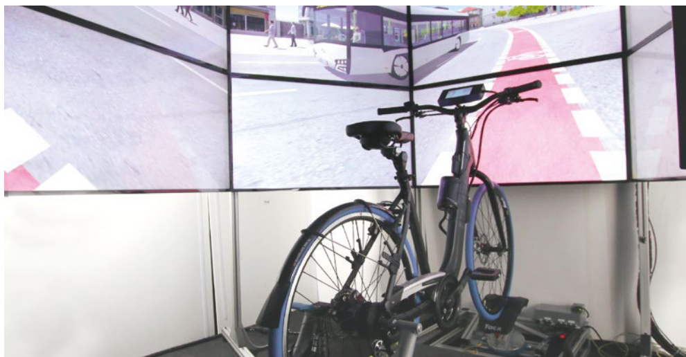
Fahrradsimulator der BAST.
