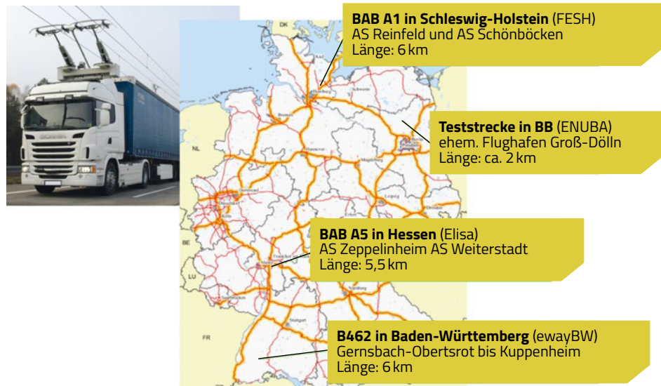
Versuchsstrecken für Oberleitungsbetrieb von Lkw.
