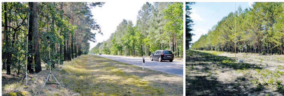
Akustische Messungen an einem Waldstreifen entlang der B97 bei Hoyerswerda.
