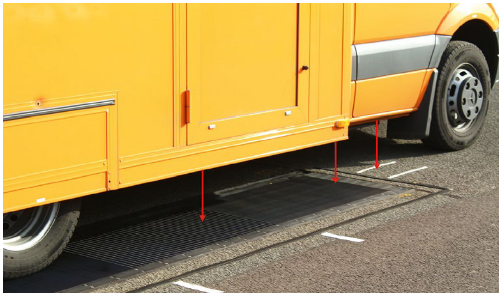
Prüfung der Lasersensorik auf dem duraBASt.
