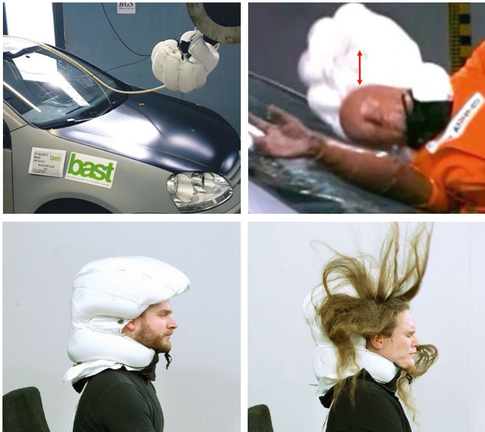
Komponentenversuche auf Motorhaube (oben links); Kopfanprall auf PKW-Front durch unzureichende Positionierung des Airbags (oben rechts); Airbag-Entfaltung bei Kurzhaarfrisur (unten links); Airbag-Entfaltung bei Langhaarfrisur (unten rechts).
