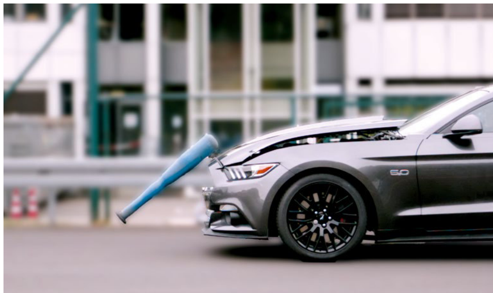
Prüfung der Sensorik eines aktiven Systems mittels Anpralltest gegen ein Fußgänger-Surrogat.
