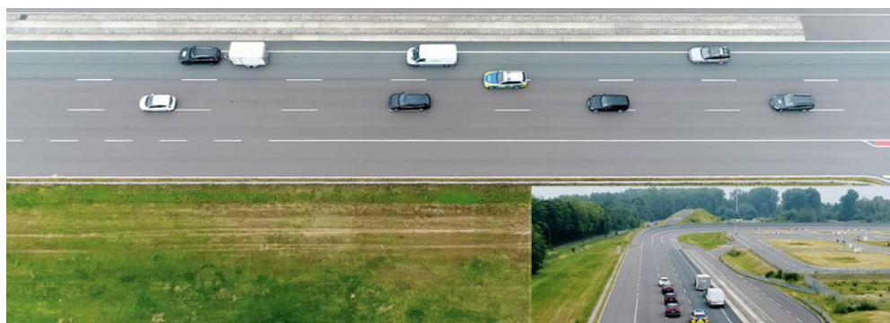
Beispieltestszenario „Rettungsgasse bilden“ für ein ALKS.
