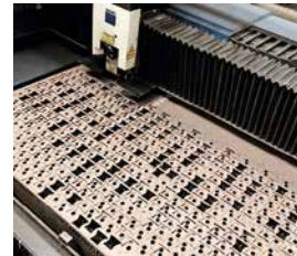
Laserzuschnitt mit hoher Toleranzgenauigkeit
