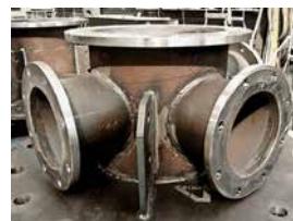
Materialverteiler aus hochwertigen Abratuberohren
