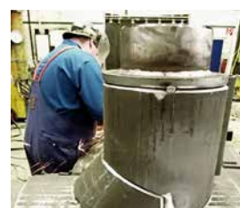
Brennerbauteil für ein Braunkohlekraftwerk
