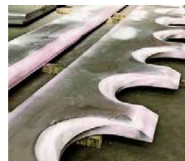
Messer mit anschl. Farbeindringprüfung
