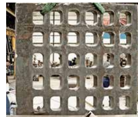
Sondersieb für einen Brecher im Steinbruch (t = 145mm)
